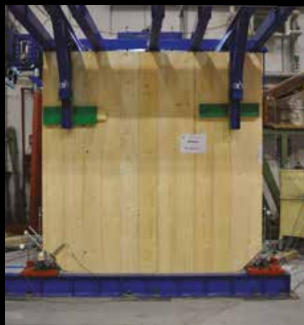
Experimentálna skúška na stenu s X-RAD a pripojenie k zemi.
