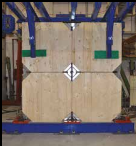
Experimentálna skúška na stenu rozdelenú na 4 časti pripojenie X-RAD.
